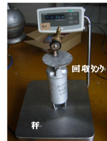
冷媒回収用タンクのはかり測定状態
