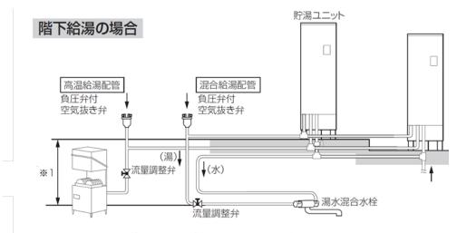
※1 給湯配管の最も高い位置から最も低い給湯口までの距離
