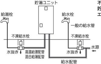
不凍水抜き栓にて水が抜かれるため 貯湯ユニット、ヒートポンプユニットが エアー噛みするおそれがあります。
