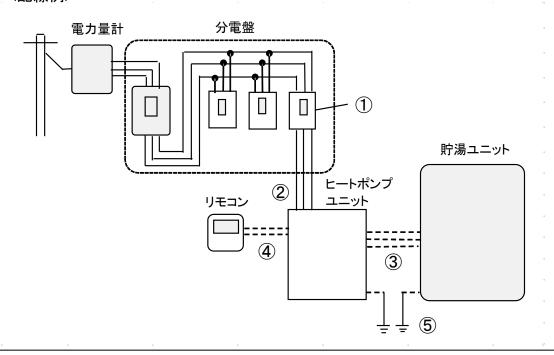
上図は漏電遮断器を機器に内蔵していない場合です。 機器内に漏電遮断器を内蔵している場合はメーカーの据付説明書に従ってください。
